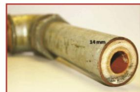
Esempio di tubazione ostruita dal calcare (calcite)
